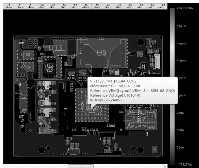
图4 核心板 IR Drop 分布图
